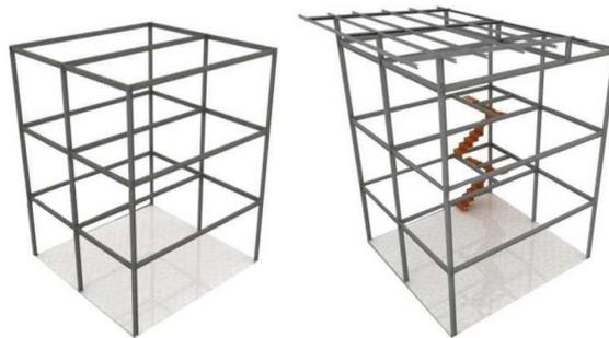
**Gambar 12.** Objek studi menerapkan struktur rangka dengan material besi WF dimensi 150x75mm
