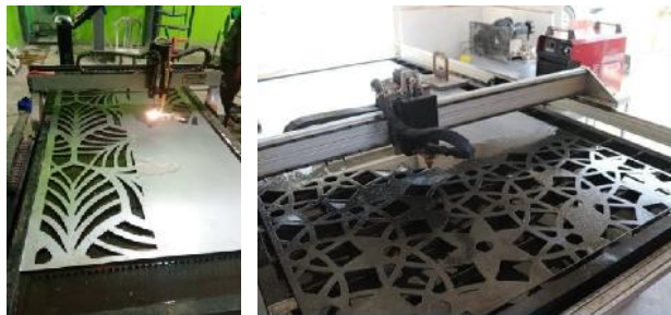
Gambar 6. Ilustrasi pembentukan pola dengan material besi
