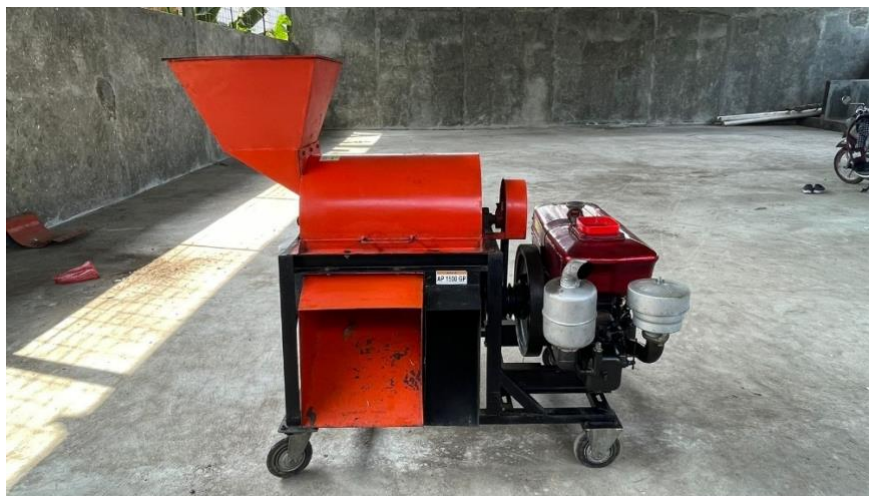
Gambar 1. Gambar Mesin Pencacah Sampah Organik
